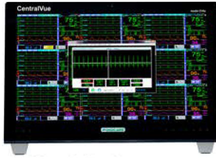
O gravador/reprodutor possui uma ferramenta de medição para fazer várias medições em forma de onda de ECG de tempo e amplitude
